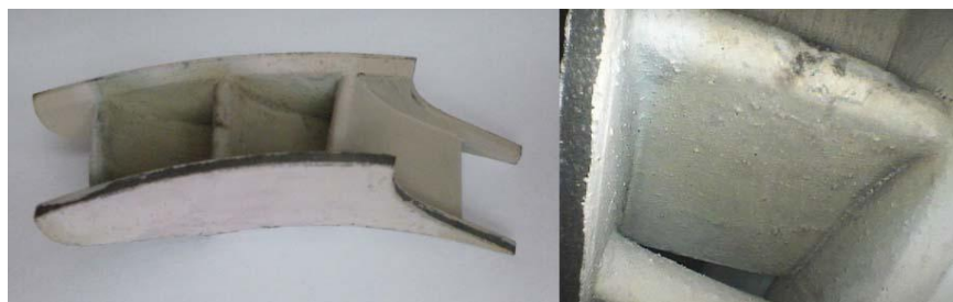
Рис. 10. Съемка термопокрытий в труднодоступных местах
