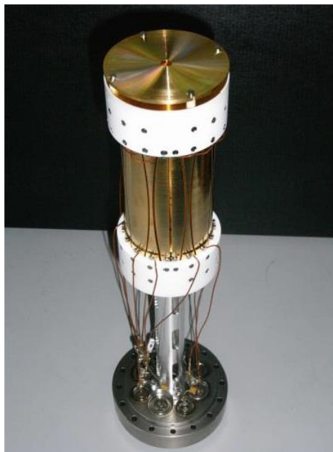
Рисунок 3. Ячейка ИЦР с динамической гармонизацией
