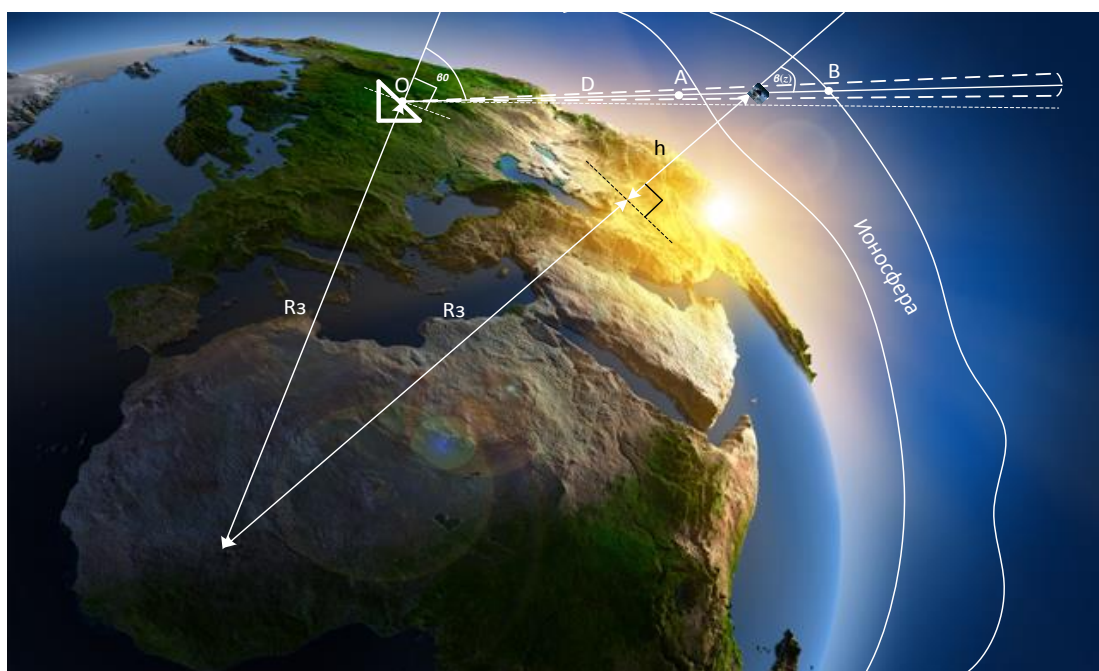
Рисунок 1 – Отображение зенитных углов и расстояний до космического объекта.
