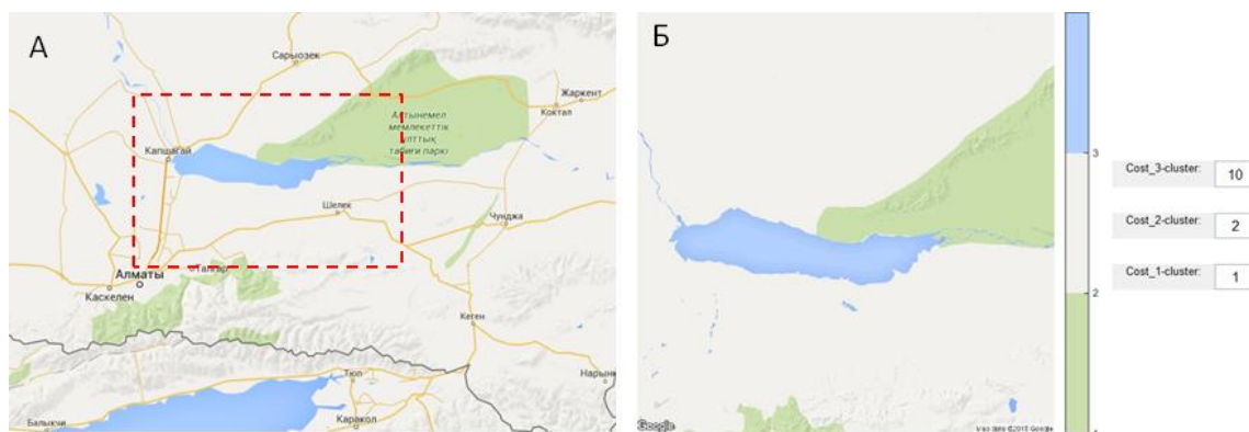
Рисунок 1. Пример взаимодействия с картографическим сервисом для выделения нужного участка (А) и сегментация изображения для автоматического создания цифровой модели (Б)
