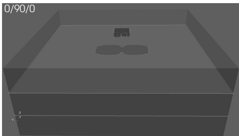
Рис. 1. Форма разрушения контакта между первым и вторым слоями в конфигурации 0/90/0. Сверху начальное воздействие на оболочку.
