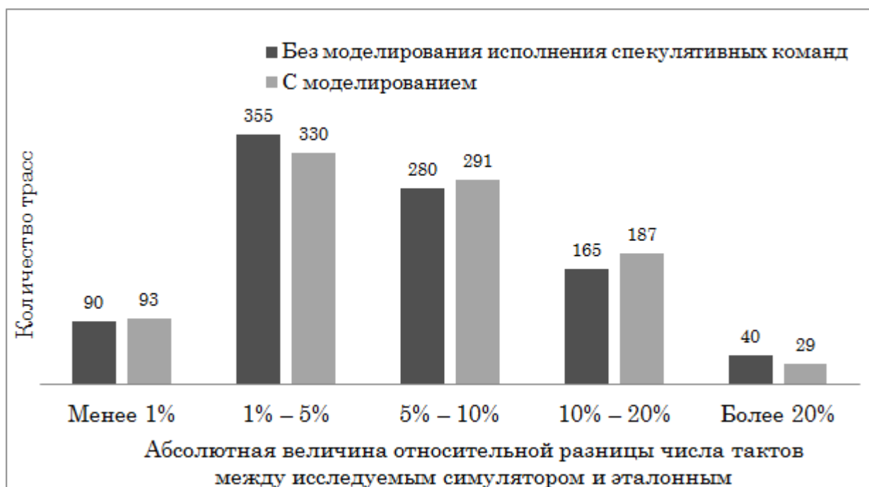
Рис. 1. Распределение трасс по точности моделирования на быстром симуляторе
