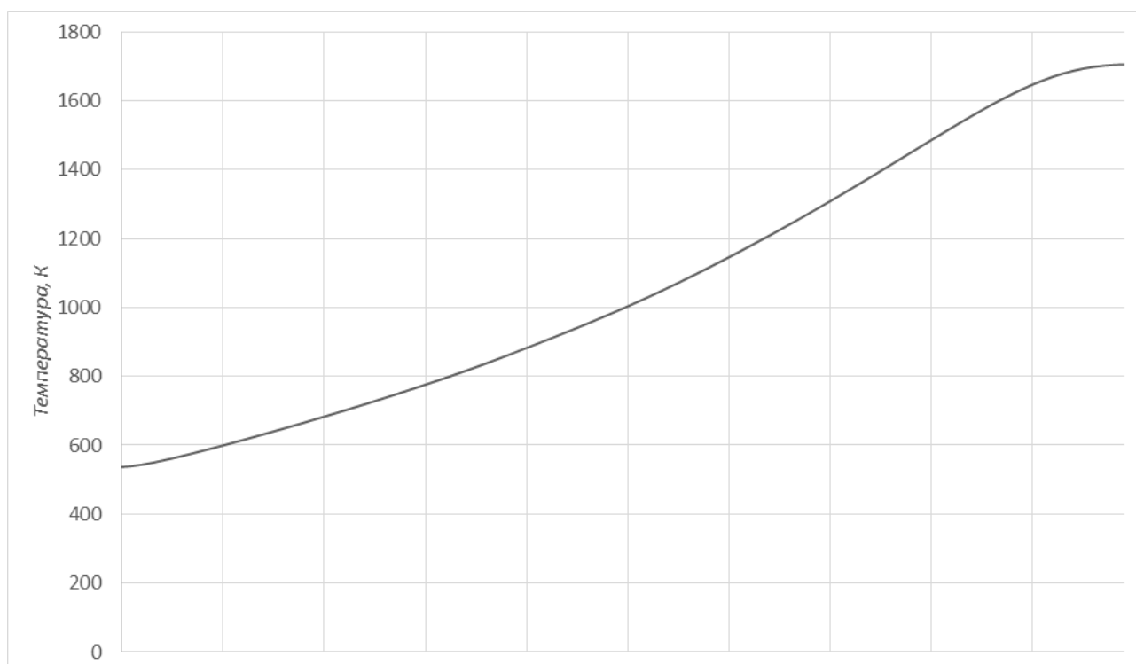
Рис. 1. Распределение температуры вдоль ниобиевой трубки.
