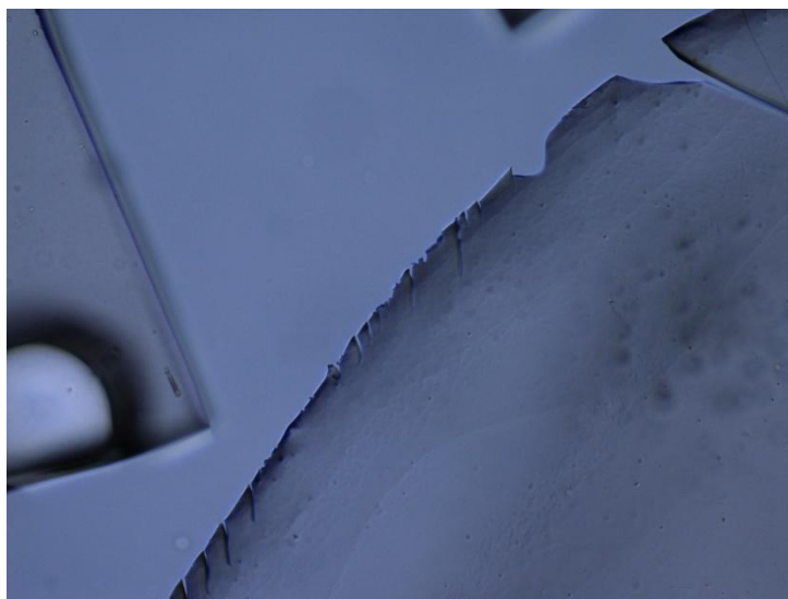
Рис. 1. Микрофотография твердой фазы красителя 4-DASPI в матрице ксерогеля на основе
