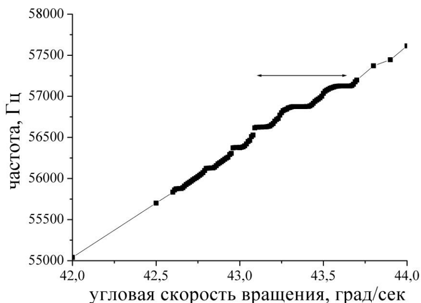
Рис. 5 Выходная характеристика лазерного гироскопа вблизи частоты подставки.
